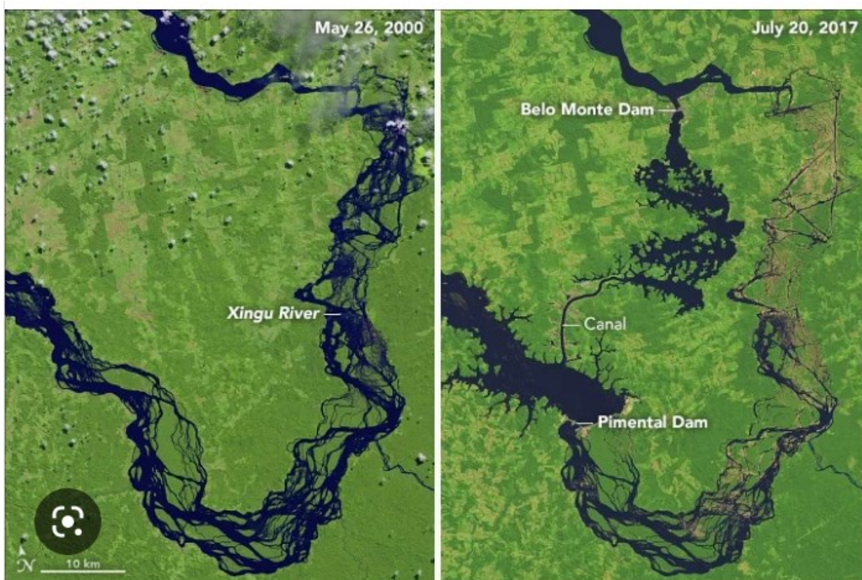
Figura 7: Imagens aéreas da bacia do Rio Xingu na área da Usina Belo Monte, demonstrando alteração do padrão deposicional antes e depois do barramento do rio (Fonte: https://o-boto.com/blog/rio-xingu-antes-e-depois-da-construcao-do-complexo-hidreletrico-belo-monte ).
